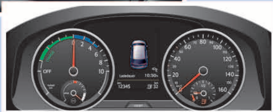
Schalttafeleinsatz mit e-spezifischen Anzeigen
