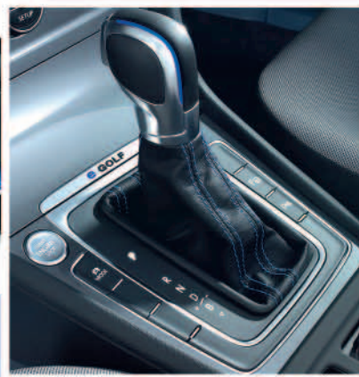
Wählhebel mit blauer Naht und Fahrstufenanzeige „B“
